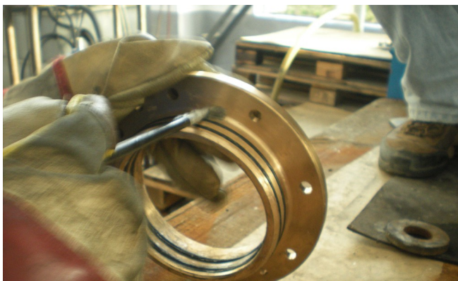
Montering och smörjning av O-ringar – steg 3
