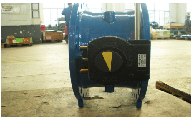
Kontroll av positionsindikator – steg 4
