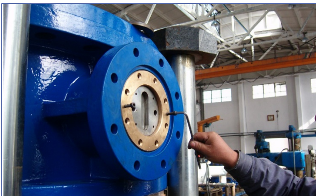
Byte av O-ring – steg 2
