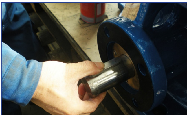
Byte av O-ring – steg 1
