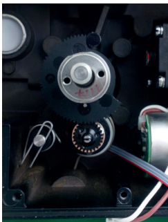
Potentiometer och kugghjul för 90° rotation
