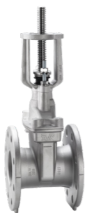
Serie 06/46 Flänsad slussventil med stigande spindel (OS&Y). Kort bygglängd, DIN F4. NBR-kil. Tillverkad helt i duplex. DN40-200
