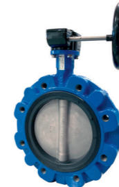
Serie 820/60 Centriskt vridspjäll med lös liner av NBR, NH liner eller FPM VD. Växel och handratt. Lug. Segjärn. DN50-400
