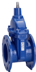
Serie 06/84 Flänsad slussventil med kort bygglängd, DIN F4. NBR-kil. AISI 316/Duplex spindel. Segjärn DN40-600 och 800. Från DN450 med ISO-fläns för manöverdon.
