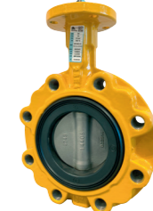
823/60-110 Centriskt vridspjäll med lös liner av NBR, NH liner eller FPM VD. För gas. Lug. Segjärn. DN50-400
