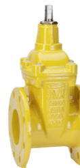
Serie 06/70 Flänsad slussventil för gas med kort bygglängd, DIN F4. NBR-kil. Segjärn DN40-600
