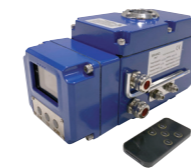
Elektriskt manöverdon Kvartsvarvsdon för bl.a. vridspjäll. 4-20 mA reglering. IP67. Hus i aluminium.
