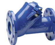
Serie 53/35 Flänsad kulventil. Segjärn. Kula vulkad i NBR-gummi. DN50-600
