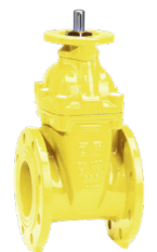
Serie 15/78 Flänsad slussventil för gas med ISO-fläns för manöverdon. Kort bygglängd, DIN F4. NBR-kil. Segjärn DN50-400
