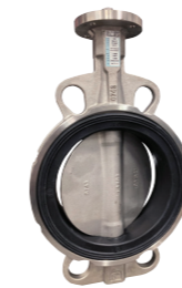
823/50-112 Centriskt vridspjäll med lös liner av NBR, NH liner eller FPM VD. Tillverkad helt i rostfritt. Wafer. DN50-400
