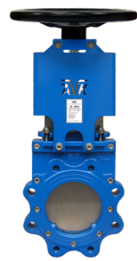
Serie 702/10 Skjutspjällsventil med icke stigande spindel och handratt. Segjärn DN50-1200
